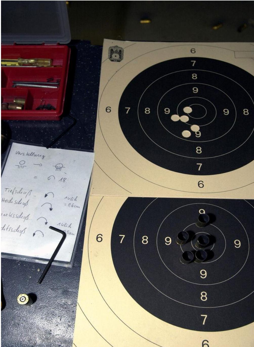
Abbildung 0.1: So soll es sein: Was hier fehlt sind ein Klick bei Tiefschuß und zwei bei Linksschuß. Richtig angesagt wurden sowohl Streukreisdurchmesser, als auch die exakte Lage der Schüsse im Rahmen des Streukreises der Waffe (22mm)
