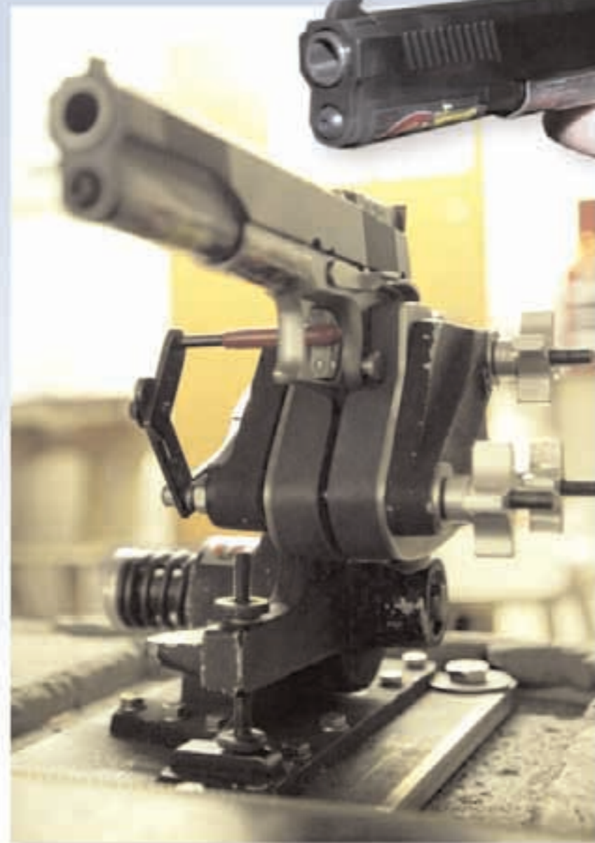
Wie man sich bettet... Das A und O von reproduzierbaren Ergebnissen mit der Ransom Rest ist eine bombenfeste Verankerung. Hier sind Gewindehülsen in Beton eingegossen.
