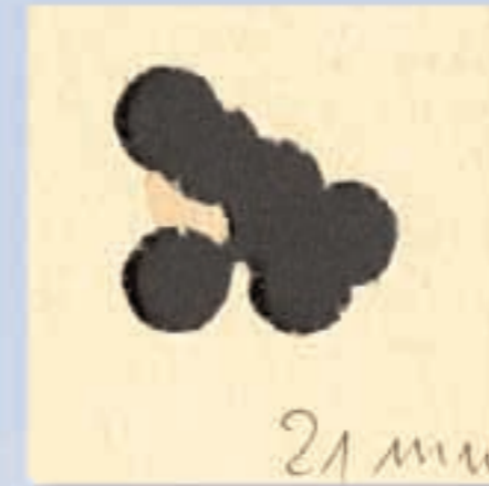
Gnadenlos. Die beste Gruppe der Ransom Rest. Sieben Schuß in 21 mm. Die schlechteste von sieben Gruppen maß 35 mm.
